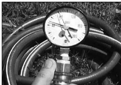
Figure 6 - Utiliser un manomètre de pression d'eau pour s'assurer que la pression d'eau de votre domicile n'est pas trop élevée.
